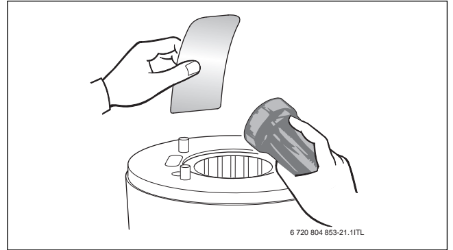
Мал. 62 Перевірка котлового блоку, який включає камеру згорання і теплообмінник, на наявність відкладень
